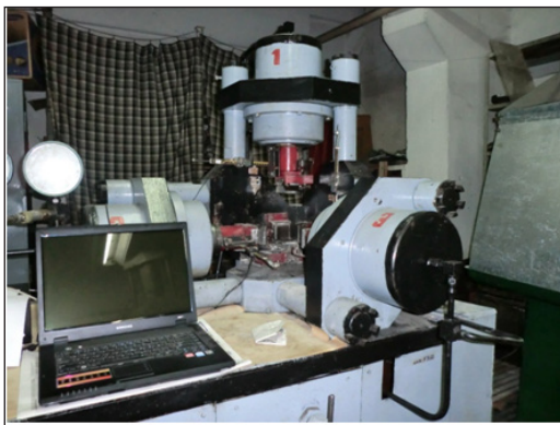
Рис. 5. Установка нерівнокомпонентного тривісного стискання конструкції (УНТС) ДонФТІ НАН України
